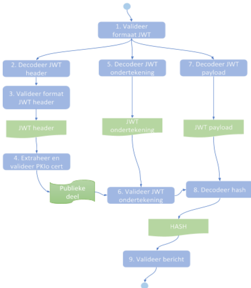
Figuur 6. Stappen die een ontvanger zet om de ondertekening van een ontvangen bericht te valideren.
